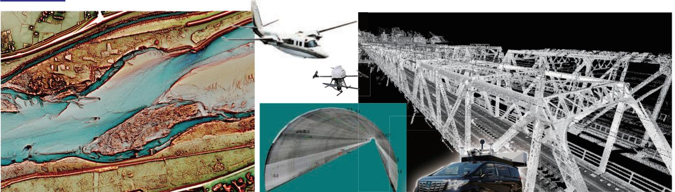
航空レーザ測深機による河川の水部と陸部の詳細地形(紀ノ川川辺橋付近)
