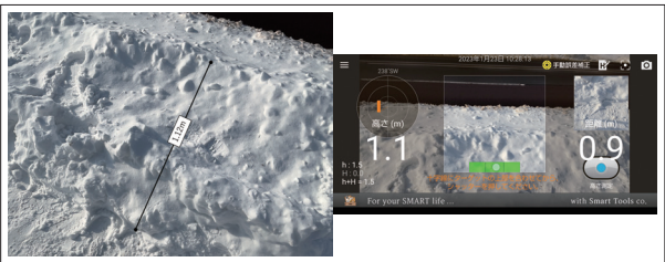
図2 堆雪の高さ計測（左：iPad 右：AQUOS）
