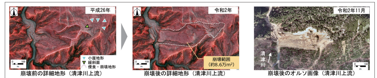
図3 清津川上流の崩壊前後の詳細地形と崩壊状況
