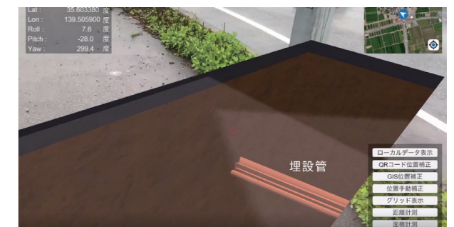
図6 現地での地下埋設物3DデータのAR表示
