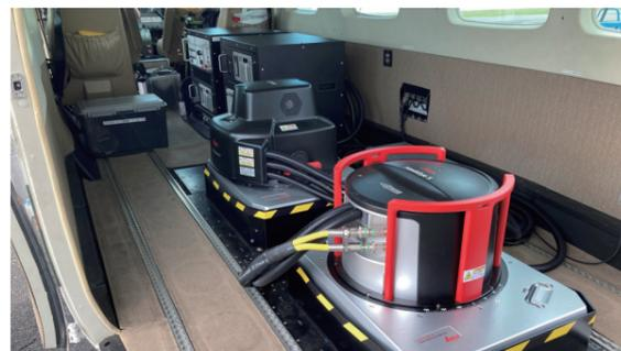
図1 固定翼機に搭載したHawkEye-5
