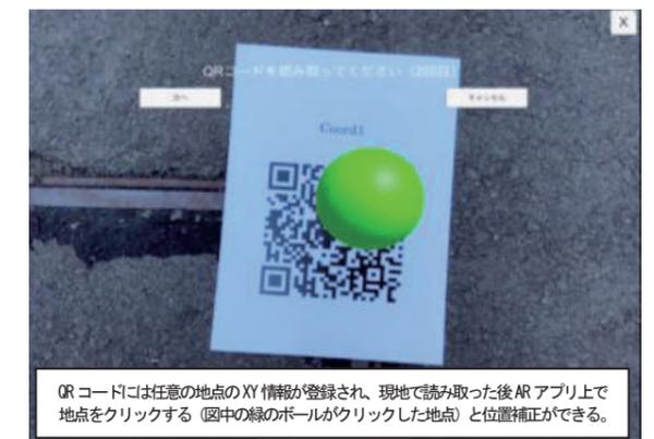
図5 QRコードを用いた自己位置補正
