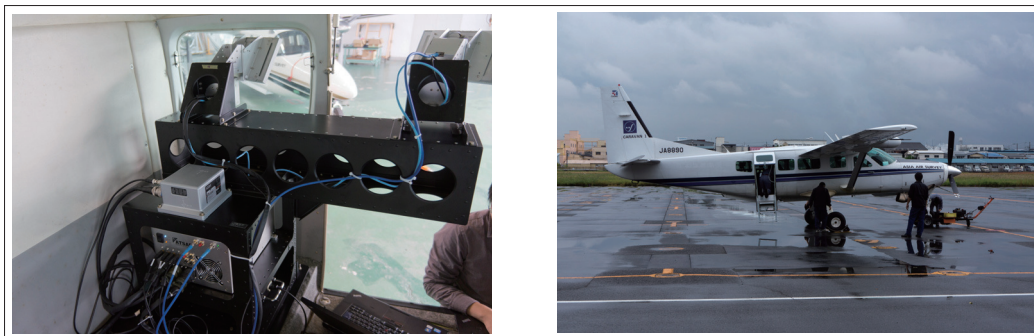
図1 ATSARの搭載状況(左)と搭載航空機(右:セスナ208)
