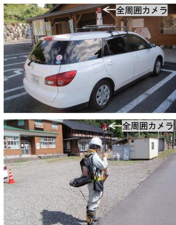
図4 撮影装置（車両型（上）、歩行型（下））
