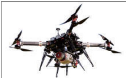
図1 レーザ搭載UAV
