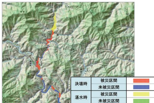
図2 河道閉塞決壊時被災評価ツールの表示画面
