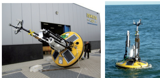
図2 ウィンド・ライダー・ブイによる風況観測
