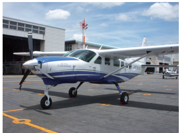
写真2 既存のセスナ式208型 (208B型と似ているが全長が少し短い。)
