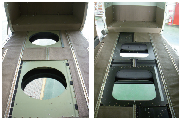
写真4 機内前方から見たカメラホール（右が新型）
