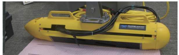
図2 スワス式測深機材（C3D）
