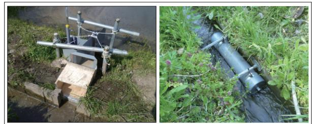
図2 流量ぜき（左）、浮遊土砂サンプラー（右）
