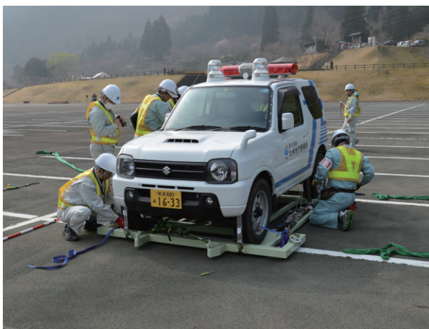
図6 架台への車両の取り付け
