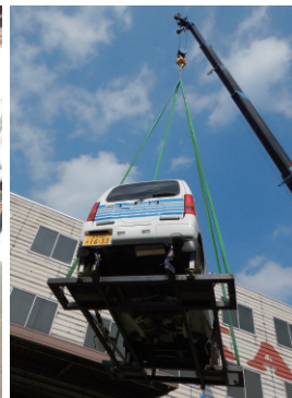
図5 吊り下げ安定度などの確認
