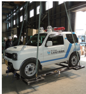
図4 総重量や変形などの確認
