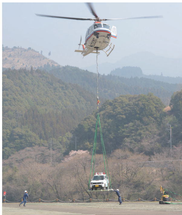
図7 ヘリコプターによる防災車両吊り下げ
