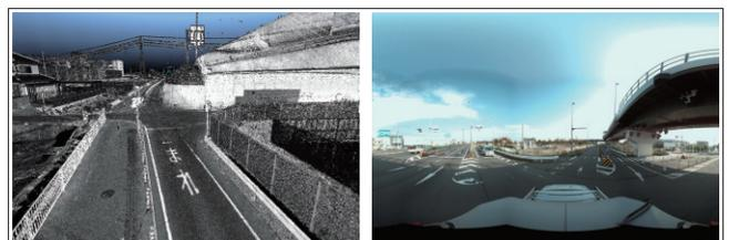
図3 MMSで取得した三次元点群と全周囲カメラ画像
