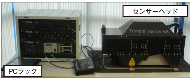
図7 レーザ計測システム (Trimble社製Harrier68i)
