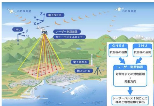
図1 航空レーザ計測の概念
