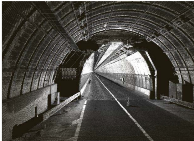
図5 トンネルの反射強度点群による俯瞰図
