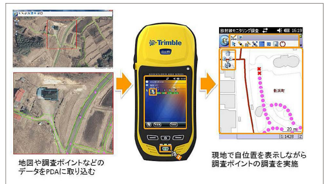
図6 高精度GPS搭載PDAを使用した放射線モニタリング
