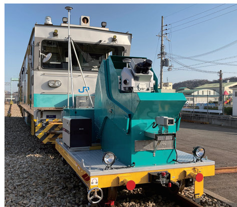
図1 鉄道MMS専用台車の外観
