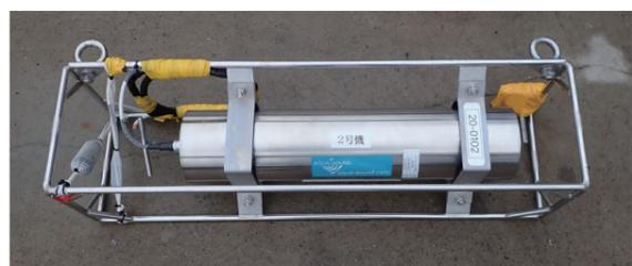
図2 水中音響録音機器 AUSOMS-V5.0
