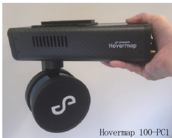
図3 SLAM技術用いたレーザ計測器
