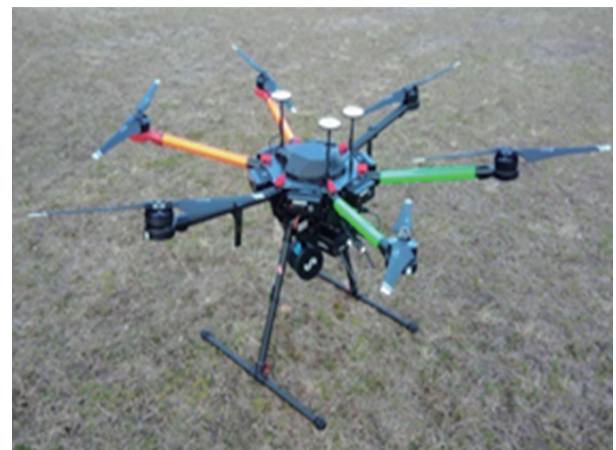
図2 SLAMレーザ計測器を搭載したUAV
