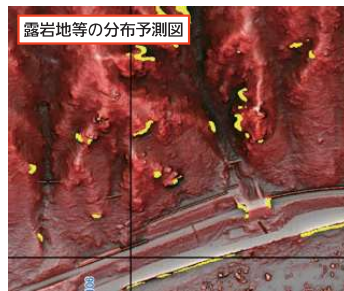
図4-2 災害要因図（岩盤崩壊）作成例
