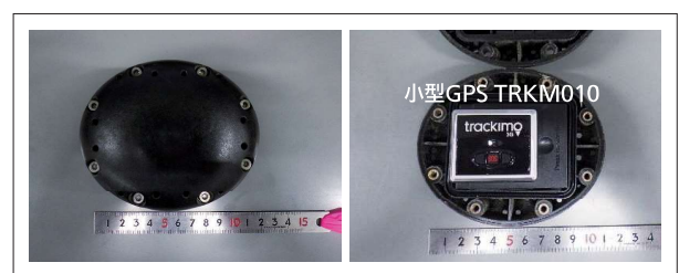
図2 制作した模擬礫（左）と使用した小型GPS（右）
