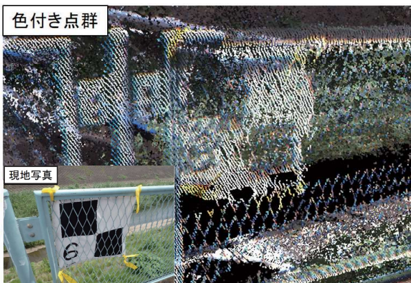
図3 地面に対して垂直に設置した調整用基準点
