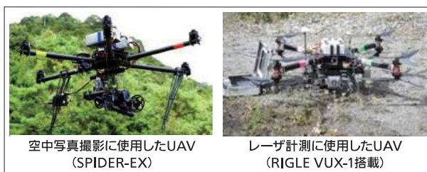
図1 計測に使用したUAV機材
