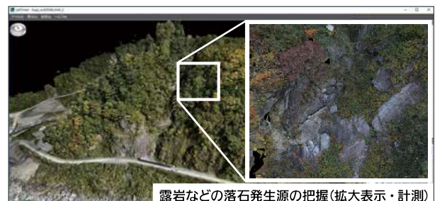
図2 UAV画像データより作成した斜面の3次元モデルと落石発生源の確認状況
