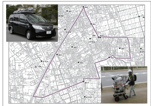
図2 検証範囲と使用したMMS (左上：車載型MMS) (右下：手押型MMS)
