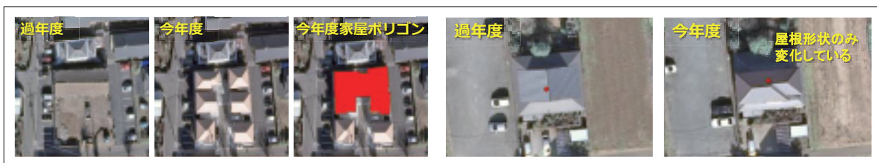
図7 不適切な自動異動判定結果の例（左：家屋ポリゴン抽出ミスによる判定誤り 右：異動抽出漏れ）
