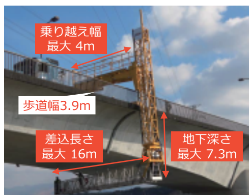
図2 歩廊式大型点検車の装備
