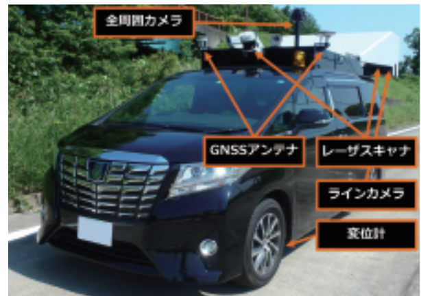
図1 路面性状調査に使用可能なMMS
