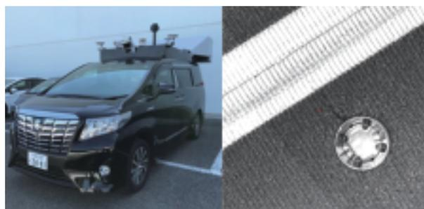
図2 MMS路面性状調査車両およびラインカメラ画像の例
