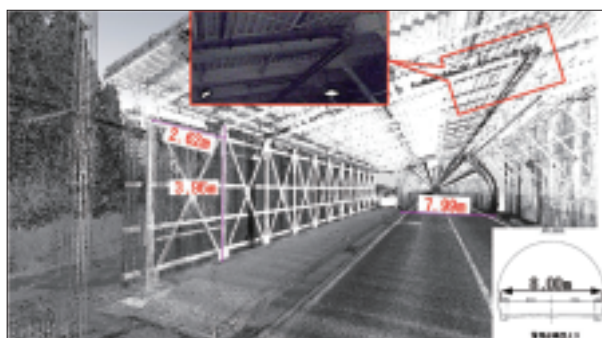
図4 構造物の形状寸法や添架物などの確認
