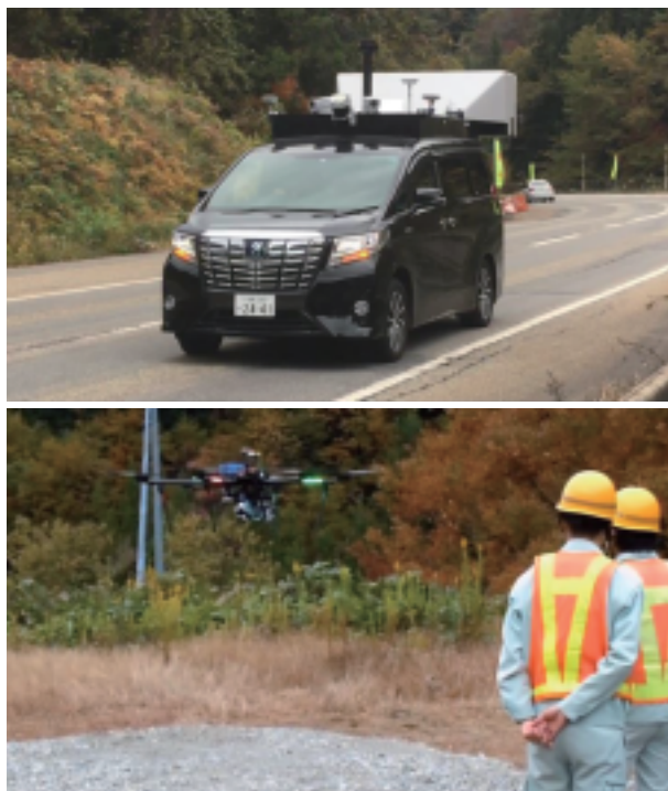
図2 計測状況（上：MMS；下：UAV）
