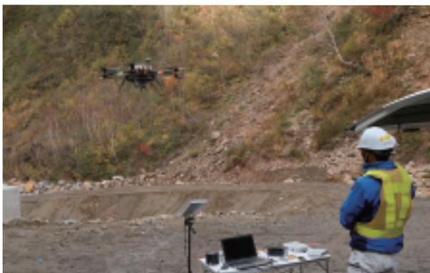
図1 UAVによるレーザ計測の状況
