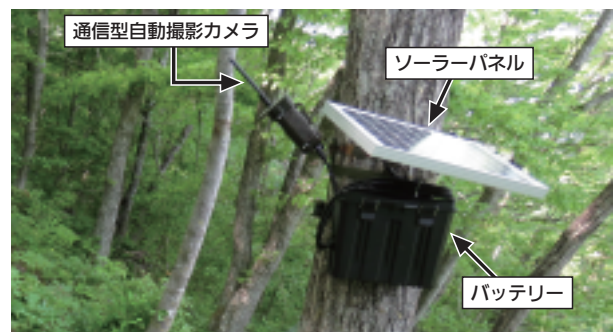
図2 無線観測システム設置例② (ソーラーパネル使用)
