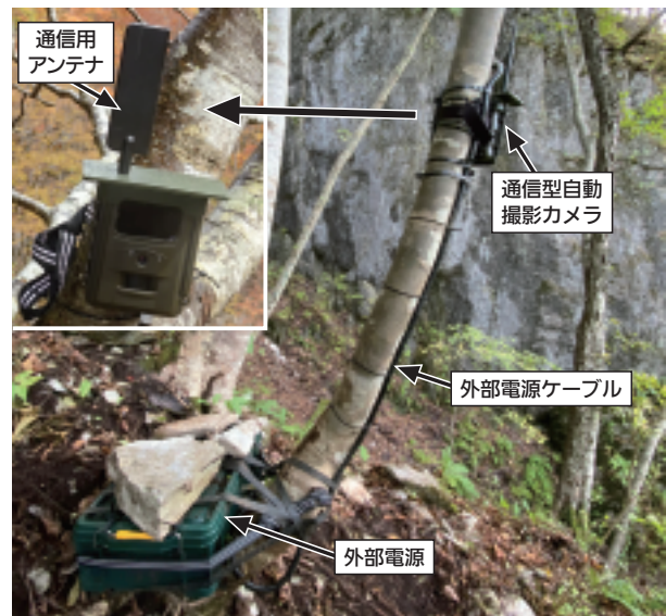
図1 無線観測システム設置例① (外部電源使用)
