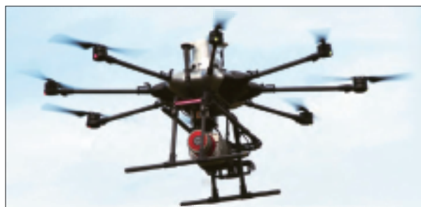
図1 本業務に用いたUAVレーザ機材の外観
