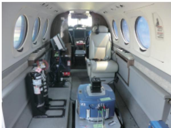
図4 デジタル航空カメラ（DMC IIe）搭載時の機内の様子
