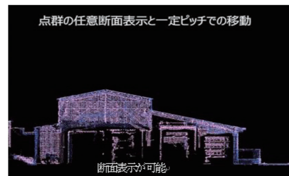
図5 施設の断面計測
