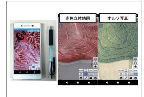
図4 Forest Trackのスマートフォンでの表示例(左)と搭載データ例(右)
