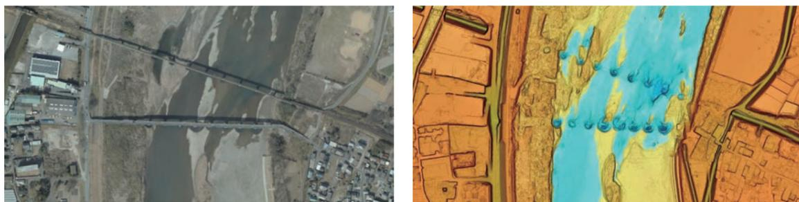
図1 橋脚周辺の河床微地形（洗掘状況）を取得した例
