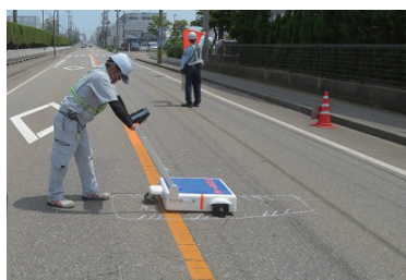
図2 地中レーダ調査の様子
