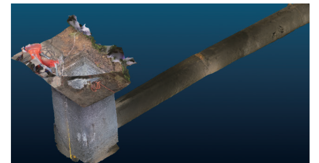
図5 排水管三次元点群データ
