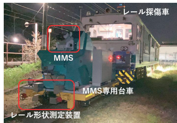
図2 レール形状測定装置 設置状況
