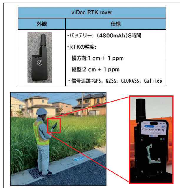
図2 RTKローバー仕様と作業風景
