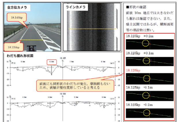
図8 全方位カメラ、ラインカメラ、三次元点群データを活用した説明資料（わだち掘れの損傷の詳細を可視化）
