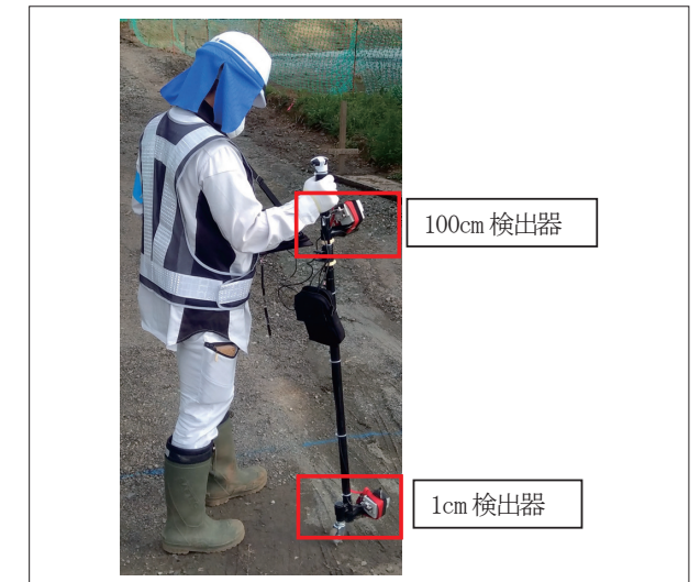
図3 ホットスポットファインダー測定状況
