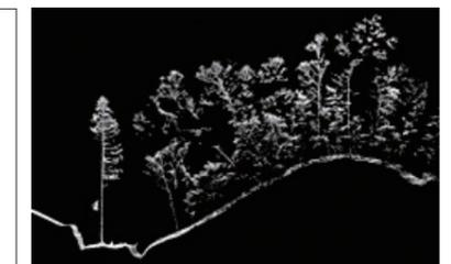
図3 MMSによって計測された点群データによって作成された樹木横断面の例（3次元データ）
