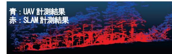
図3 UAVとSLAMデータの重ね合わせ断面図
