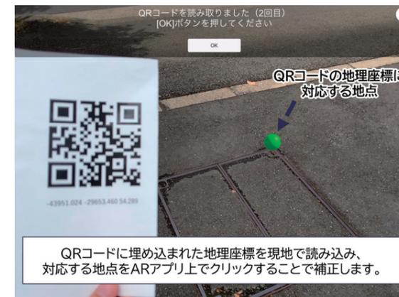
図2 QRコードを用いた自己位置・方位の設定
