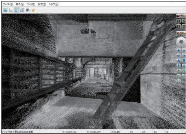
図2 歩行型レーザスキャナ計測データ
