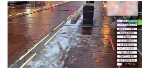
図2 水道施設GISデータのAR表示
